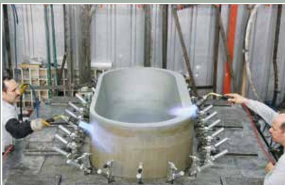
Préchauffage du moule de la baignoire, dont la hauteur est réglée en fonction du modèle souhaité (en îlot ou semi encastrée).
