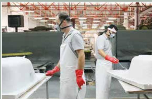
Vaporisation des flocons de fibre de verre. Cela permet d'éviter la présence de bulles d'air dans la couche intermédiaire (car il y a plusieurs couches dans une baignoire). Finition par usinage manuel du surplus de fibre de verre.
