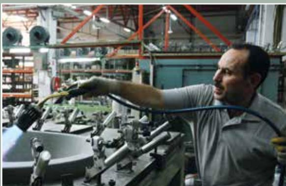
Suite au démoulage, la forme obtenue est gardée en température, au niveau de la bordure supérieure. Ce moulage reste ainsi à la forme souhaitée.
